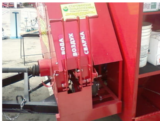
Рис. 10.8. Привод узлов агрегата от ВОМ трактора
